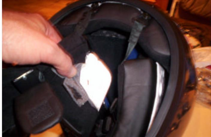
An beiden Teilen, dort wo die Ohröffnungen vermutet werden, Markierungen anbringen. So viel vom Styropor wegnehmen, bis die Hörer bündig abschließen. Ich habe einen LötKolben (statt Spitze eine „Schaufel“ nehmen) benutzt. Das ist ein sauberes Arbeiten. Die Aussparung für die Kabel nicht vergessen. Hörer und Kabel habe ich mit Heißkleber befestigt.
