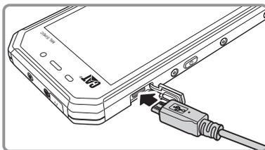
3. Stecken Sie das andere Ende des Kabels in das Ladegerät und dieses in eine Steckdose.
